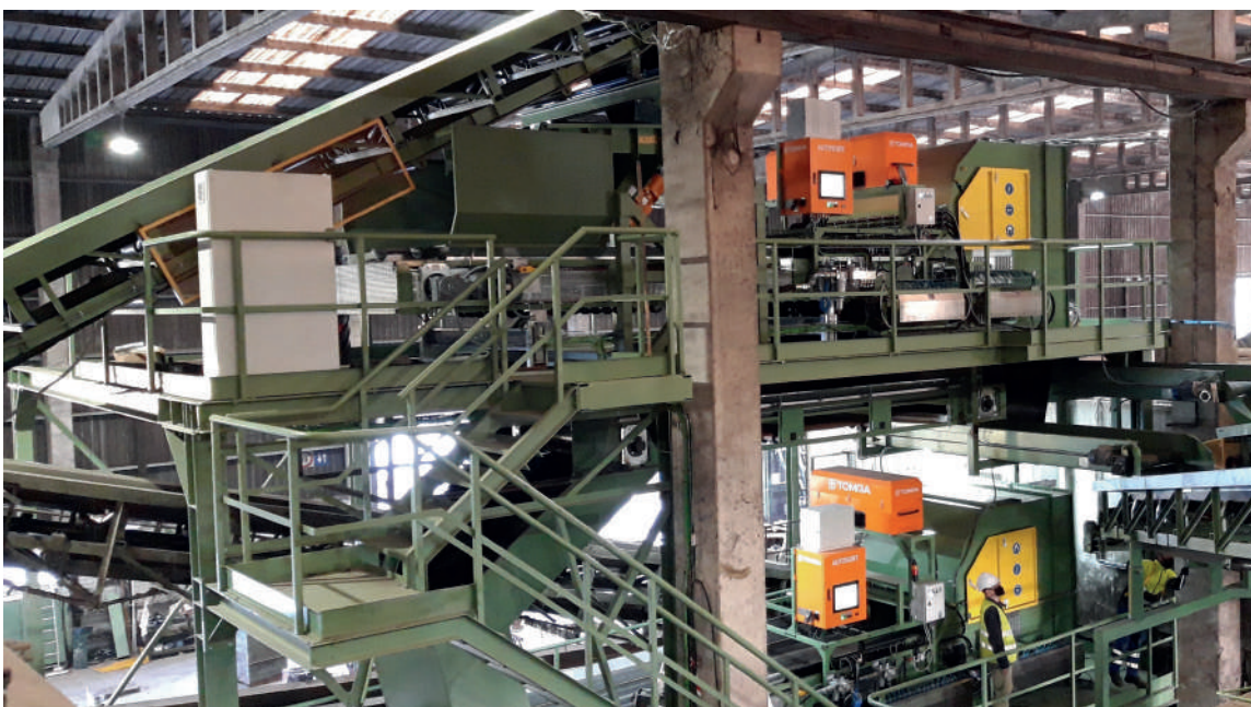
Equipos automáticos de selección en la planta de selección de envases en el CITRSU Montemarta Cónica.
